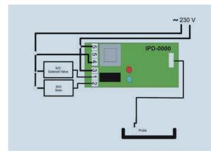
Der Relais-Ausgang kann jede beliebige Vorrichtung (Gerät) aktivieren, wie zum Beispiel eine Sirene oder eine größere Lichtanzeige
