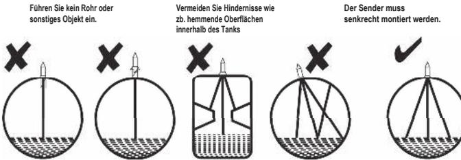
Überprüfen Sie das Display des Tankalert Eco Oil-Überwachungsgerätes 2 Stunden nach der Montage des Senders und stellen Sie fest, ob das Tankalert Eco Oil-Überwachungsgerät den Füllstand im Balkendiagramm sowie Informationen über die Ölmenge auf dem Hauptbereich des Displays anzeigt. Sollte dies nicht der Fall sein, schlagen Sie bitte im Abschnitt "Fehlerbehebung" des Tankalert Eco Oil-Produkthandbuchs nach.
