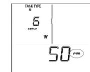
**SETUP 6 (betrifft nur Tanks von Type B & C) - Einstellung der Tankbreite (cm).** Entnehmen Sie die Tankbreite aus der oben angeführten Tabelle und stellen Sie das angezeigte Maß in cm mit den Tasten  $\Delta/\nabla$  ein. Drücken Sie die EINGABE-Taste, um zu speichern.
