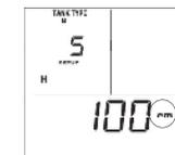
**SETUP 5 – Einstellung der Tankhöhe (cm).** Entnehmen Sie die Tankhöhe aus der oben angeführten Tabelle und stellen Sie das angezeigte Maß in cm mit den Tasten  $\Delta/\nabla$  ein. Drücken Sie die EINGABE-Taste, um zu speichern. Beachten Sie, dass, falls Tank-Type „A“ ausgewählt wurde, das SETUP 6 übersprungen wird.
