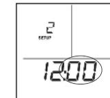
**SETUP 2 – Einstellung der Uhrzeit (Minuten).** Stellen Sie die angezeigte Minutenzahl mit den Tasten  $\Delta/\nabla$  um. Drücken Sie die EINGABE-Taste, um zu speichern.
