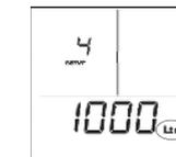
**SETUP 4 – Einstellung des Tank-Fassungsvermögens (l).** Entnehmen Sie das Nennfassungsvermögen aus der oben angeführten Tabelle und stellen Sie die angezeigte Menge in Litern mit den Tasten  $\Delta/\nabla$  ein. Drücken Sie die EINGABE-Taste, um zu speichern.
