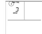
**SETUP 2 – Einstellung der Tank-Type.** Wählen Sie die Tank-Type (z.B. A, B oder C) mit den Tasten  $\Delta/\nabla$  aus, die der Type entspricht, die Sie vorher aufgeschrieben haben. Drücken Sie die EINGABE-Taste, um zu speichern.
