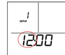
**SETUP 1 – Einstellung der Uhrzeit (Stunden).** Stellen Sie die angezeigte Stundenzahl mit den Tasten  $\Delta/\nabla$  um. Drücken Sie die EINGABE-Taste, um zu speichern.
