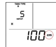
**SETUP 5 – Einstellung der Tankhöhe (cm).** Entnehmen Sie die Tankhöhe aus der oben angeführten Tabelle und stellen Sie das angezeigte Maß in cm mit den Tasten  $\Delta/\nabla$  ein. Drücken Sie die EINGABE-Taste, dass, falls Tank-Type „A“ ausgewählt wurde, das SETUP 6 übersprungen wird.
