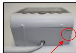
Bild 2: Ausrichtungs-Stift
