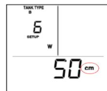
**SETUP 6 (betrifft nur Tanks von Type B & C) - Einstellung der Tankbreite (cm).** Entnehmen Sie die Tankbreite aus der oben angeführten Tabelle und stellen Sie das angezeigte Maß in cm mit den Tasten  $\Delta/\nabla$  ein. Drücken Sie die EINGABE-Taste, um zu speichern.
