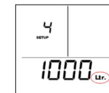
**SETUP 4 – Einstellung des Tankfassungsvermögens (L).** Entnehmen Sie das Nennfassungsvermögen aus der oben angeführten Tabelle und stellen Sie die angezeigte Menge in Litern mit den Tasten  $\Delta/\nabla$  ein. Drücken Sie die EINGABE-Taste, um zu speichern.
