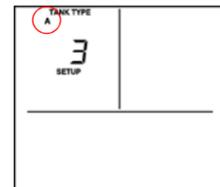
**SETUP 2 – Einstellung der Tank-Type.** Wählen Sie die Tank-Type (z.B. A, B oder C) mit den Tasten  $\Delta/\nabla$  aus, die der Type entspricht, die sie vorher aufgeschrieben haben. Drücken Sie die EINGABE-Taste, um zu speichern.
