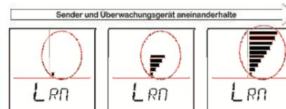
Nach dieser "Synchronisierung/Abstimmung" sendet der Tankalert Eco Oil-Sender dem Tankalert Eco Oil-Überwachungsgerät verschiedene Daten durchgehend im Abstand von etwa 10 Minuten. Jedes Mal, wenn das Tankalert Eco Oil-Überwachungsgerät eine Meldung erhält, wird ein Klickgeräusch ertönen, wobei die rote LED auf dem Tankalert Eco Oil-Überwachungsgerät blinken wird (was dem "Schnell"-Modus des Senders entspricht).
