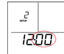
**SETUP 2 – Einstellung der Uhrzeit (Minuten).** Stellen Sie die angezeigte Minutenzahl mit den Tasten  $\Delta/\nabla$  um. Drücken Sie die EINGABE-Taste, um zu speichern.
