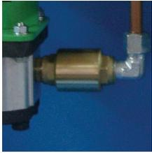
Es könnte in einigen Fällen zum Eindringen einer harten, festen Verschmutzung kommen und somit zu einer Undichtigkeit am Ventilsitz. Versuchen Sie, die Verschmutzung ohne Ausbau zu entfernen. (Indem der Ölschlauch abmontiert wird.) Falls dies nicht möglich sein sollte, Ventil ersetzen. (Dieses wird durch vorsichtiges Erwärmen der Verschraubung entfernt, wobei darauf geachtet werden sollte, dass keine anderen Bauteile zu stark erhitzt werden.)
